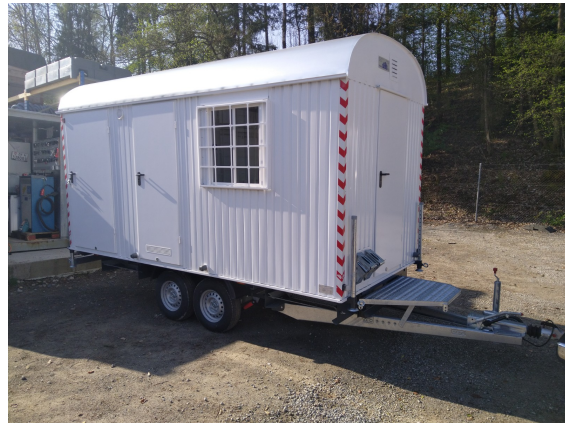
Tandemachsen 4.0, 4.5, 5.0, 5.5, 6.0m, mit, Auflauf-+Feststellbremse oder Druckluftbremse, Gesamtgewichte bis 6'000 kg
