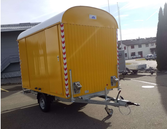
Einachsler 3.0, 3.5, 4.0, 5.0 m, mit Auflauf- + Feststellbremse, Gesamtgewichte bis 1'900 kg
