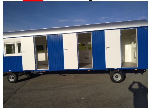
Zweiachser als Schnellläufer mit Druckluft- und Feststellbremse oder als Langsamläufer 25 Km/h mit Auflauf und Feststellbremse auf Vorderachse wirksam
