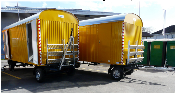
Zweiachser als Schnellläufer mit Druckluft- und Feststellbremse oder als Langsamläufer 25 Km/h mit Auflauf und Feststellbremse auf Vorderachse wirksam
